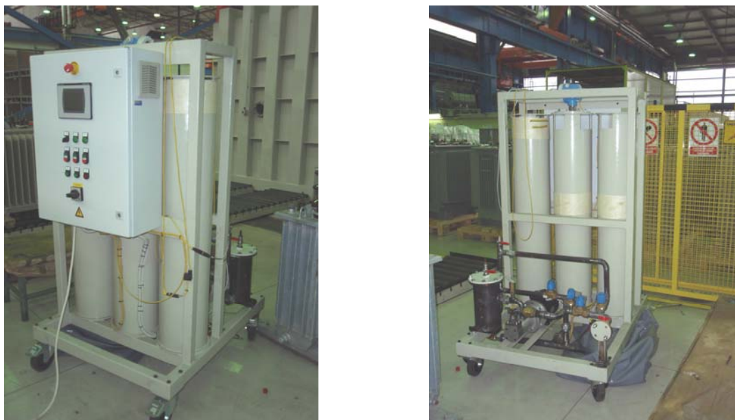
Slika 1. Uređaj za ispitivanje transformatorskih kotlova
