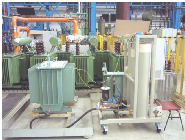
Slika 5. Ispitivanje životnog vijeka transformatora
