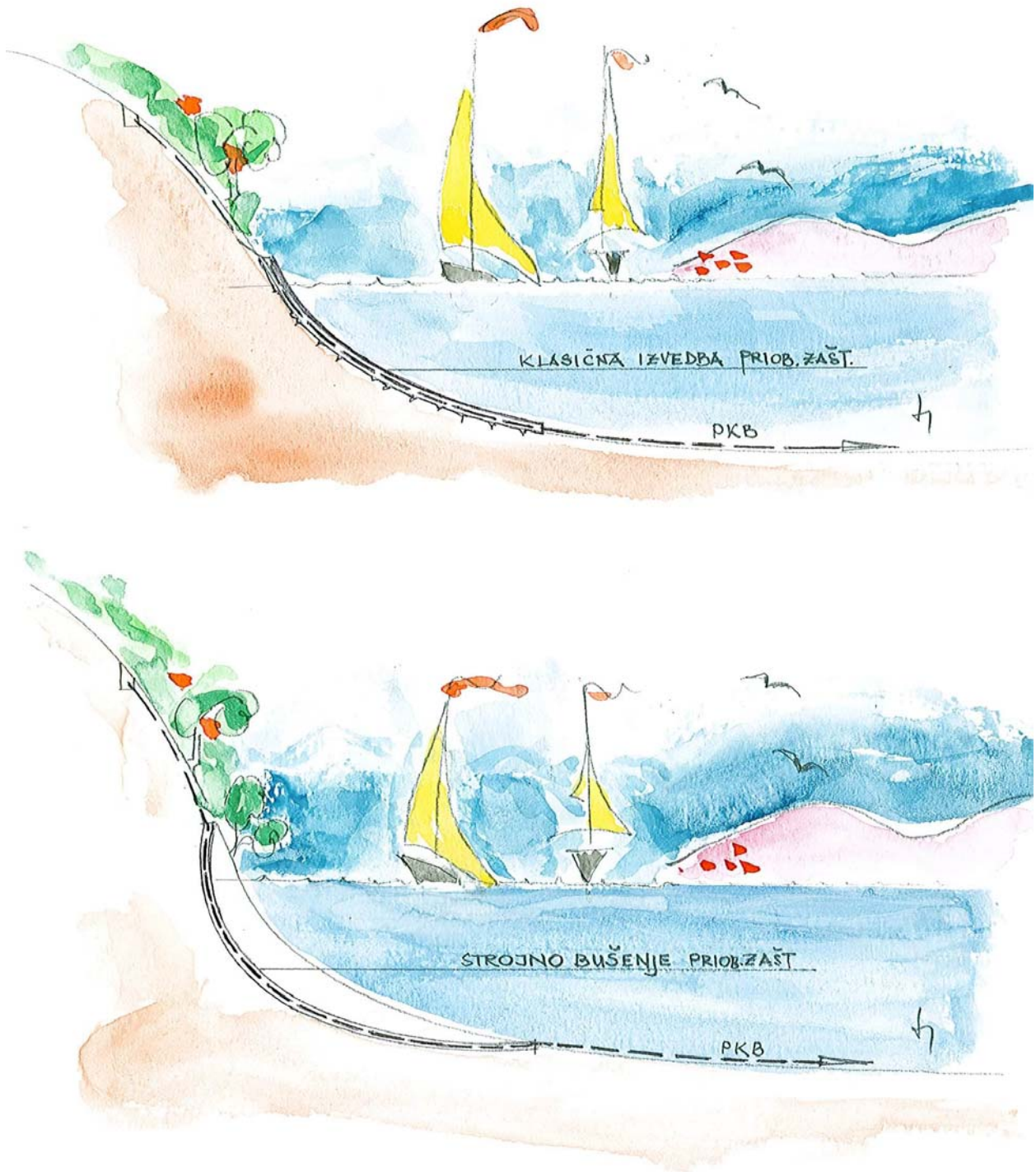
Slika 2. Skica izvedbe priobalne zaštite klasičnim načinom i strojnim bušenjem
