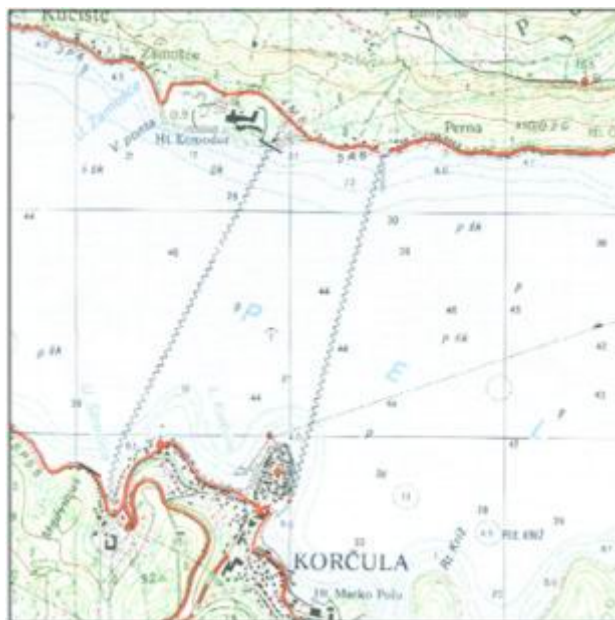
Slika 3. Izlazne točke PKB 110 kV KORČULA (Strečica) - PELJEŠAC (HC Komodor) na gradskoj i hotelskoj plaži
