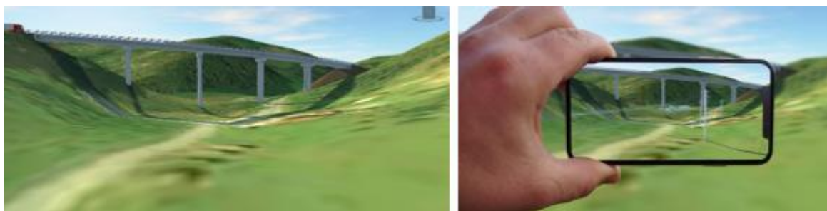
Slika 7. Primer BIM prikazan „na terenu“ uz pomoć telefona kroz proširenu realnost na mestu izgradnje voda
