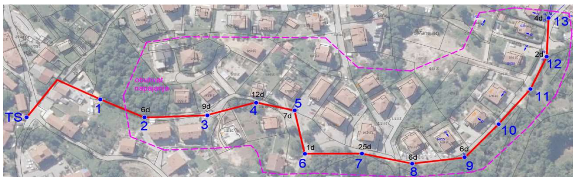
Slika 7. Izvod niskonaponske mreže iz TS 20/0,4 kV Mavri 3
