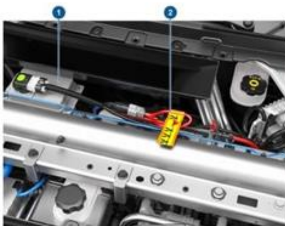
Slika 8. Mjesta isključenja 12V sustava: 1) konektor 12V baterije, 2) mjesto za prekid u nuždi [8]
