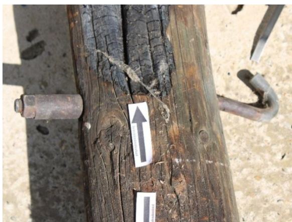
Slika 3: gornji dio opožarenog stupa
