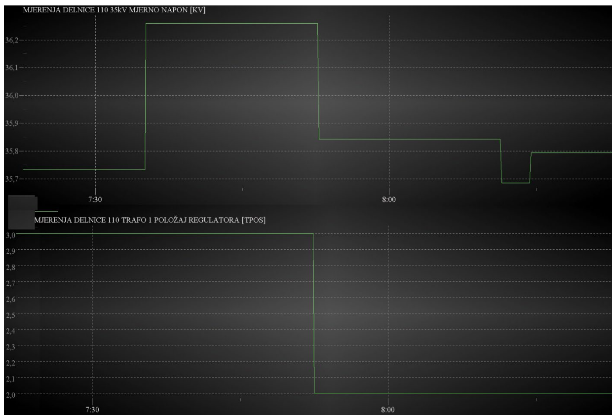
Slika 10. Podaci iz WS500, ispad transformatora T2 u TS 110/35kV Delnice
