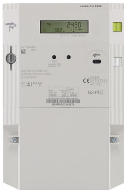
Slika 4. Trofazno ZMXi310A PLC G3 brojilo [3]
