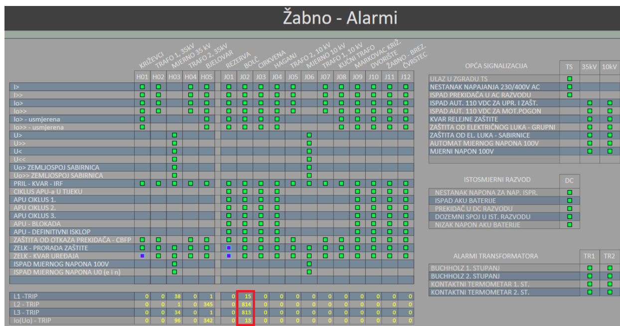
Slika 2. Prikaz alarma TS 35/10(20) kV Žabno u SCADA sustavu nakon APU-a na DV Bolč
