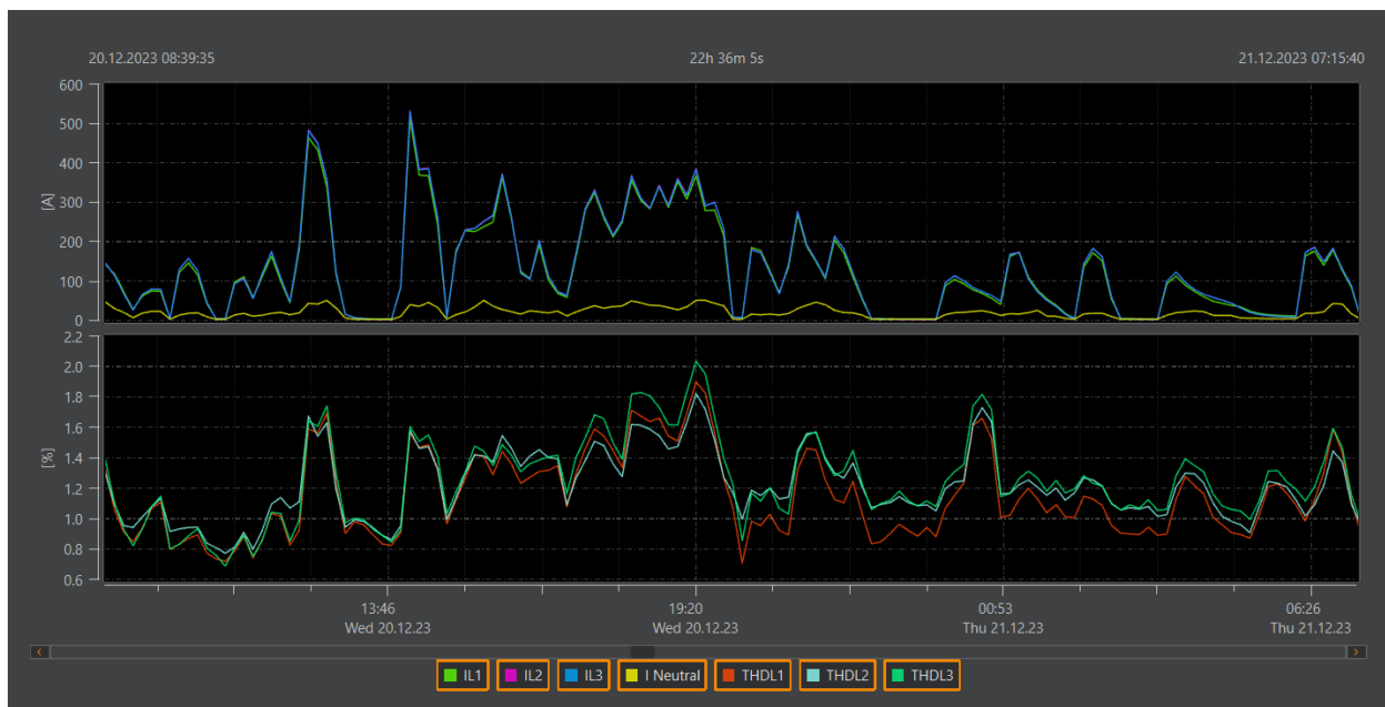
Slika 6. Korelacijski odnos efektivnih vrijednosti struja ultra - brzog punjača i naponskog THD-a
