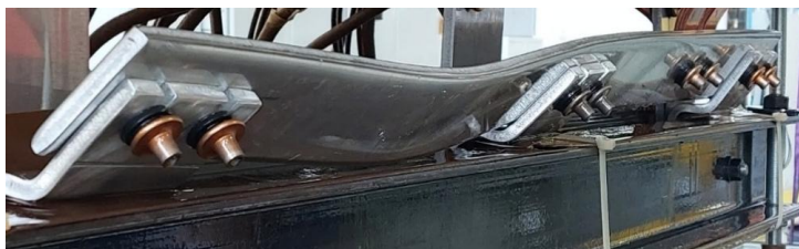
Slika 4. Primjer plastične deformacije NN zvjezdišta nakon testa izdržljivosti (ispitivanje prototipa)
