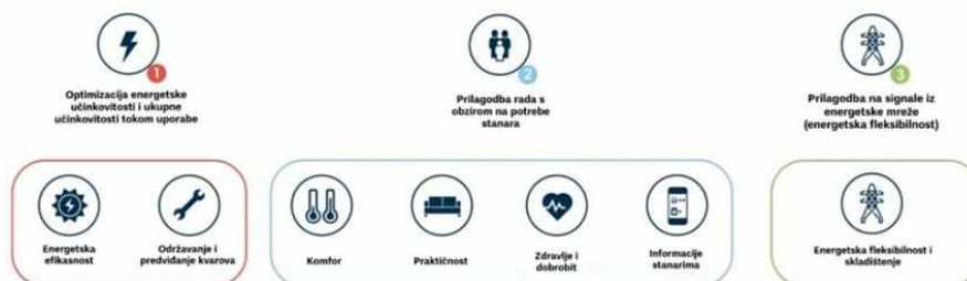
Slika 4. Tri ključne funkcije s kriterijima za mjerenje pripremljenosti zgrade za pametne tehnologije [5]
