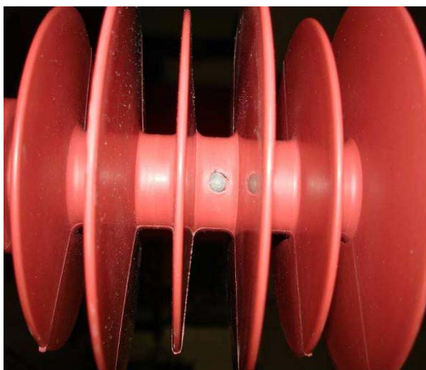
Slika 2. Prikaz namjernog oštećenja izolatora svrdlom
