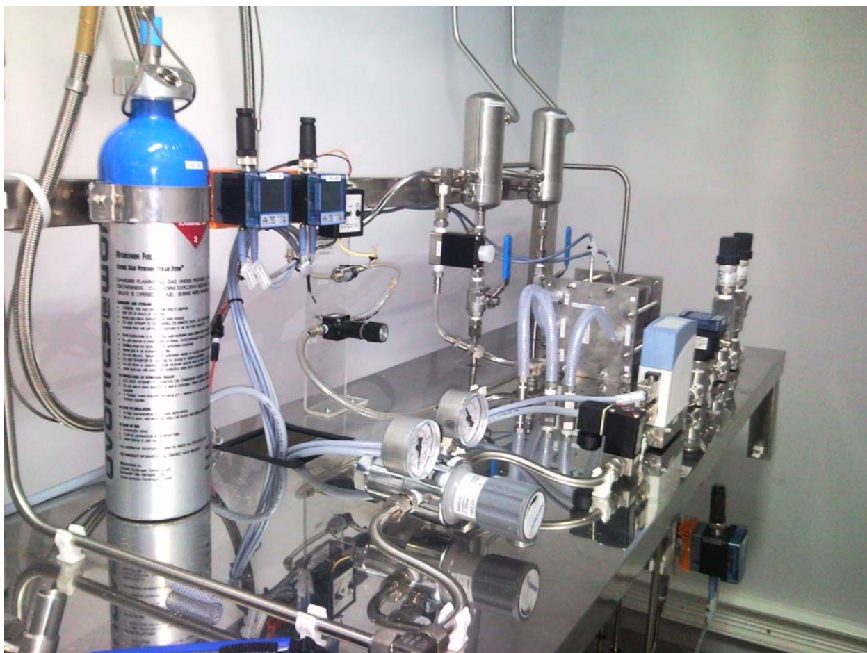
Slika 7. Smještaj dijela agregata zasnovanog na vodikovom gorivnom članku.
