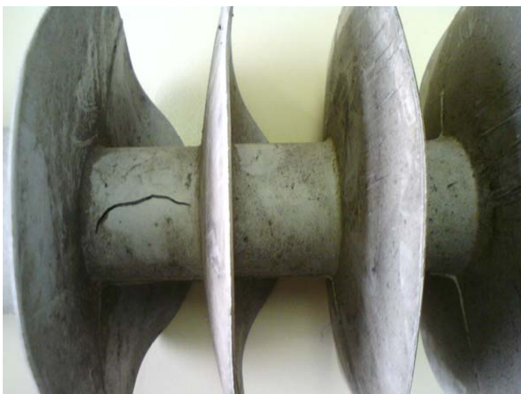
Slika 1. Prikaz kvara na kompozitnom izolatoru ugrađenom na 10 kV vodu Bolč
