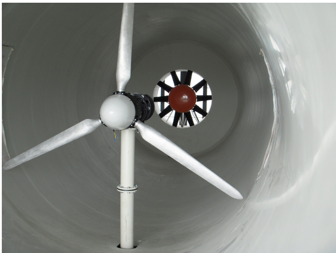
Slika 4. Smještaj vjetroturbine u vjetrokomori Laboratorija.
